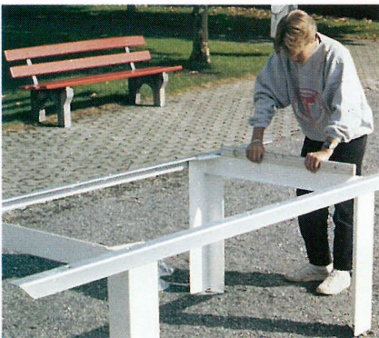
Die Platten von unten durch die Löcher in den Längswinkeln anschrauben.
