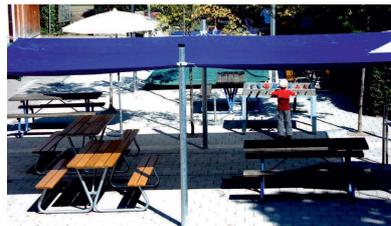
Hochwertiger Gittermarkisenstoff Soltis-86, 86% Lichtschutz - 380 g/m<sup>2</sup>, Rohrpfosten verzinkt - Ø89 mm, 300 cm lang, zum Einbetonieren mit Fixierbohrungen und Abschlusskappen.
